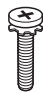
Parafusos do suporte 8 de cada, M4 x L20 (Apenas UB83**-ZB) (Consulte a p. A-4) 4 de cada, M4 x L20 (Apenas UB80**, UB82**, UF695*-ZB) (Consulte a p. A-3)
